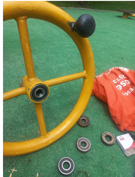
Se reajustaron, engrasaron y cambiaron algunas piezas de las maquinas de los biosaludables
